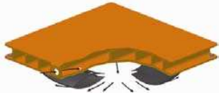
Querschnitt durch ein Load Module™ Aero-Caster® zeigt den Luftstrom während des
