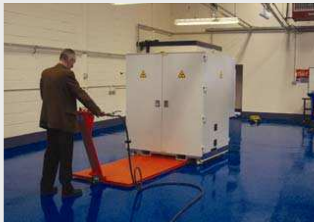
Das AirShuttle™ wird zum Verfahren einer Röntgenkabine von 4 Tonnen benutzt.
